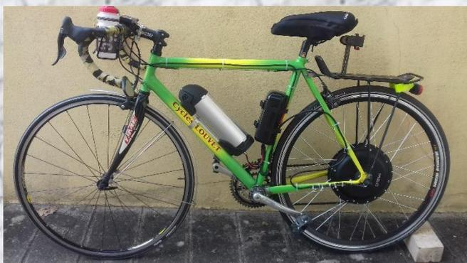
Mon plus gros problème a été le pneu arrière Schwable 700x25c non adapté à ce poids, ce qui a entraîné 4 crevaisons non dues à des trous, mais à des pincements de la chambre à air lors de passage sur des mauvais revêtements ou des creux sur la route. Et pour changer la chambre à air de la roue arrière avec le moteur, il faut compter deux fois plus de temps qu'avec une roue normale.
